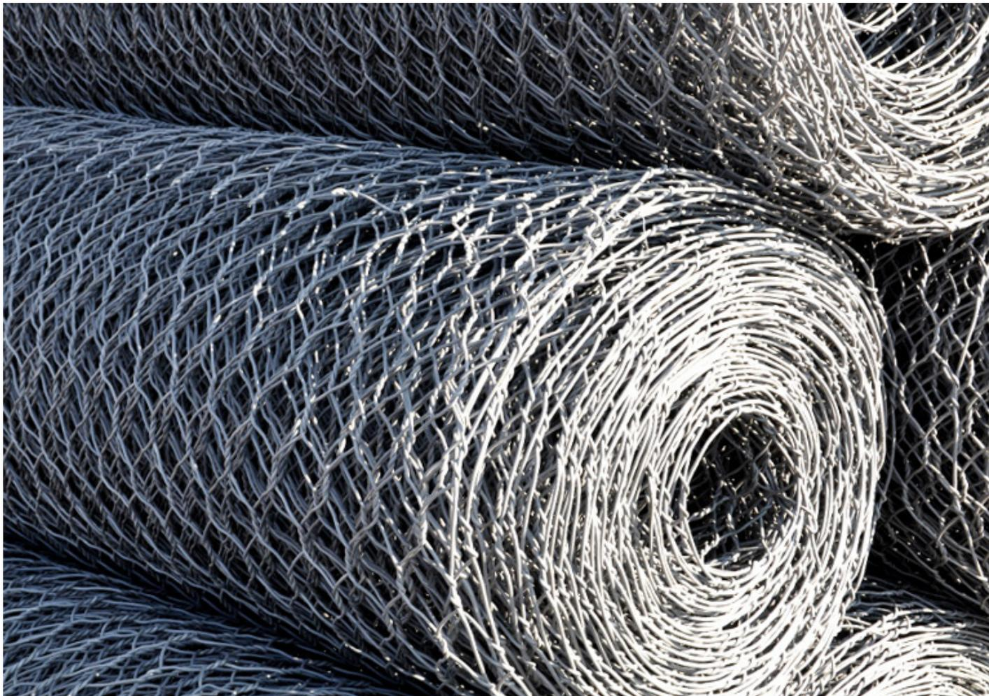
Сетка двойного кручения для габионов – это полотнище с ячейками шестиугольной формы (визуально напоминают пчелиные соты). Каждая ячейка образуется из двух проволок путем ее соединения (скручивания) с соседними ячейками. Для изготовления материала используется стальная проволока, защищенная цинком. Для создания кромок применяется армировочная проволока большего диаметра.
