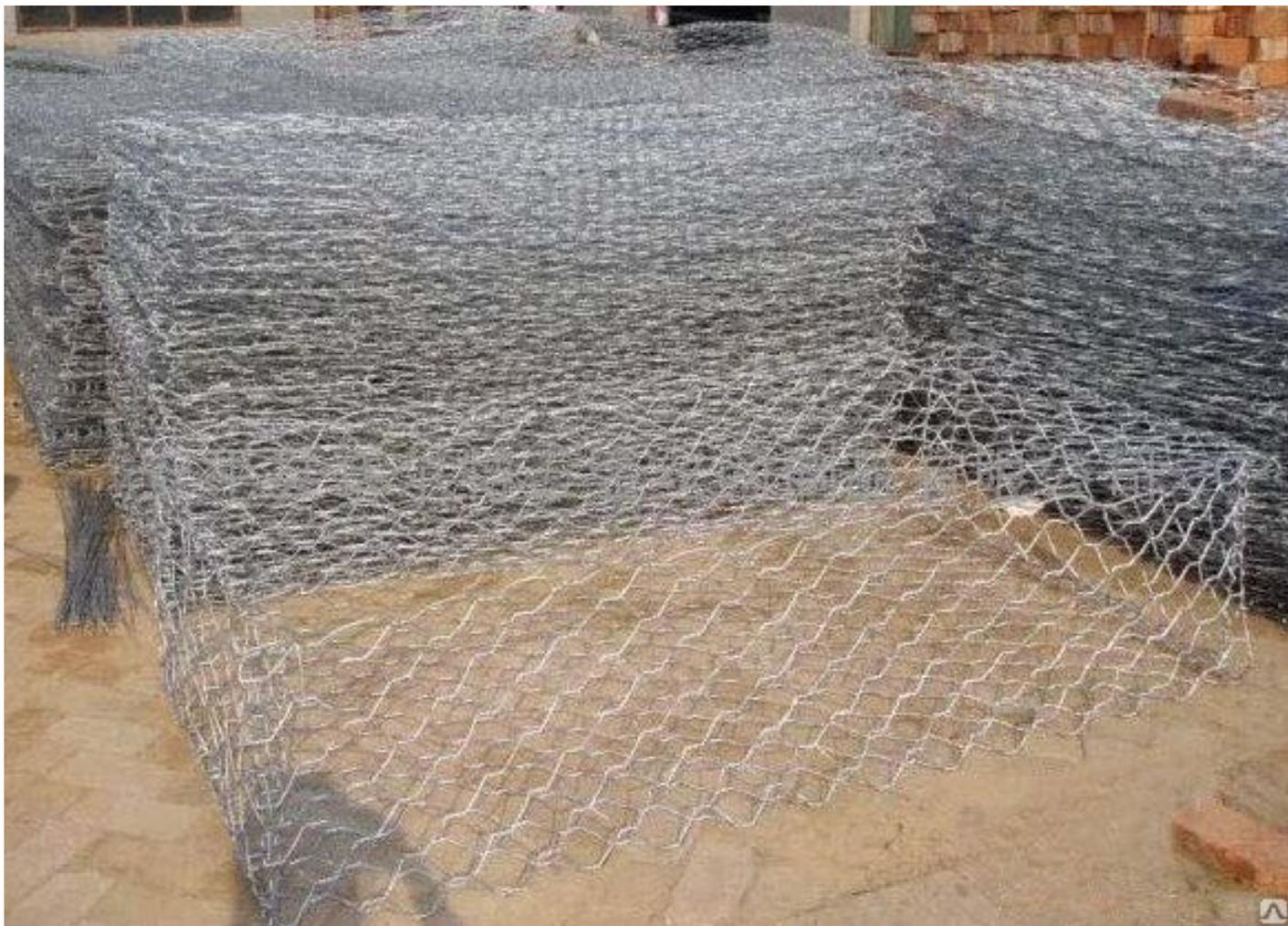
Габионы с армирующей панелью – пространственные конструкции коробчатого типа, усиленные специально выпущенными участками сетки. Как и обычные габионы, они изготавливаются из сетки двойного кручения с шестиугольными ячейками. При этом днище конструкции и панель для армирования представляют собой единое сетчатое полотно (их изготовление по отдельности с последующим соединением считается нарушением технологии).
